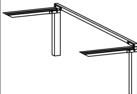
7. Заложить задний брус и соединить его с резиновой лентой при помощи сдёргиваемых заклёпок.
